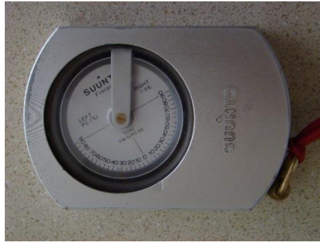
Figure 7-: Suunto PM-5/360 PC clinometer
